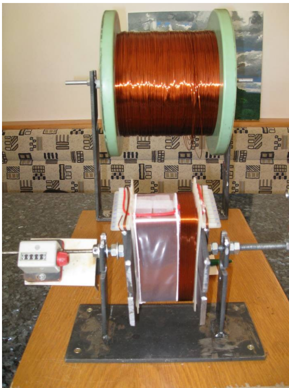
Abb. 13: Trafo Wickelgerät, die Primärwicklung ist fertig gestellt
