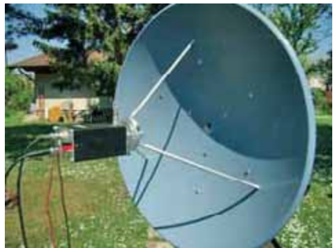
OE3WOG 76 GHz Transverter im Brennpunkt der Antenne
