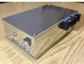
Auch die im Originalbausatz des LIMA befindliche 1W PA wurde optimiert und erzeugt jetzt mindestens 5 Watt. Somit ist sie nun als vollwertiges QRP Gerät verwendbar. Und zudem ausreichend um eine 100 W Endstufe anzusteuern. Natürlich sind die Endstufen nicht nur mit dem Lima SDR, sondern auch für andere Projekte und Transceiver verwendbar.
