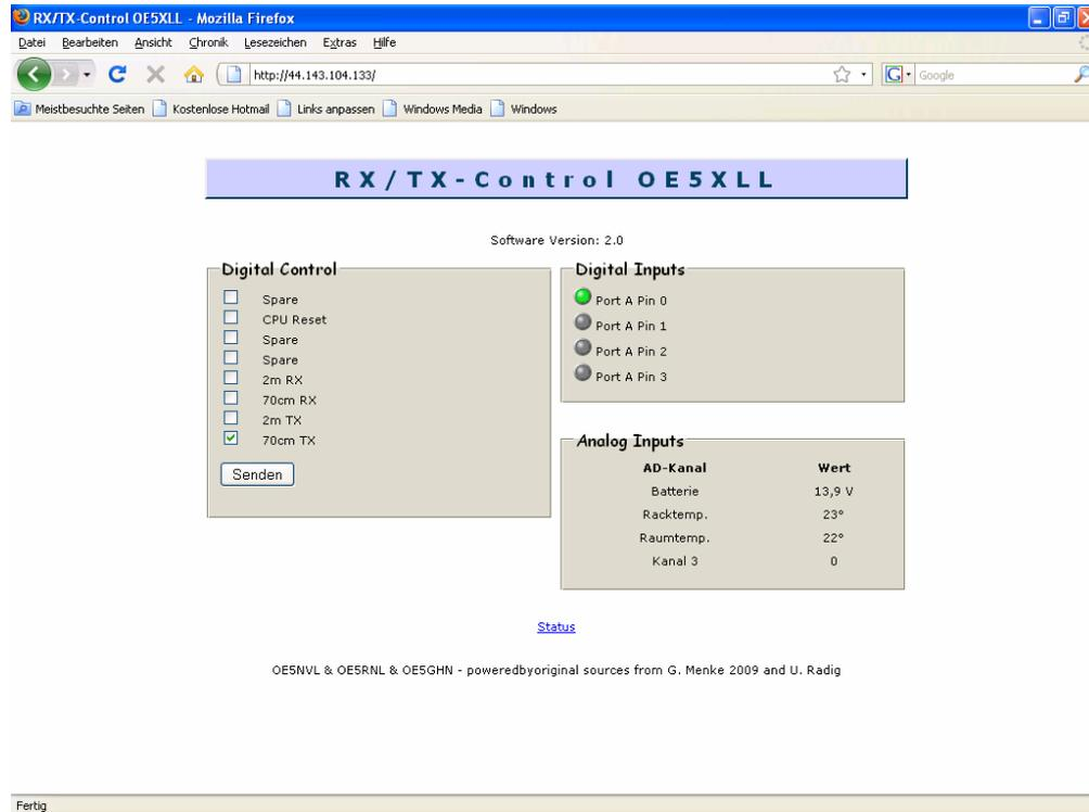
Die Bildschirmansicht zeigt auf der linken Seite das Control-Panel. Durch setzen eines Haken wird der jeweilige Ausgang aktiviert. Der Zustand wird im EEPROM gespeichert und nach einem Reset oder Stromausfall wieder hergestellt.
