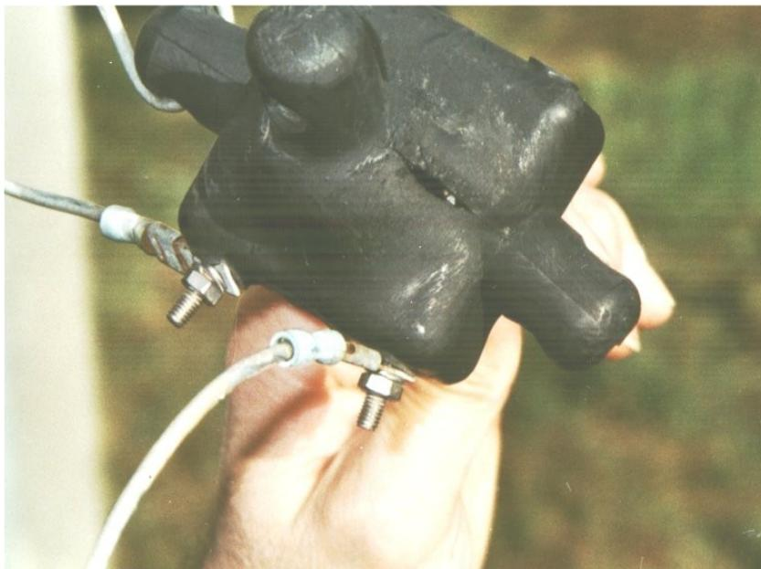
*Bild 1: Balun der FD4 nach Mißbrauch der Antenne auf 160 Meter.*
