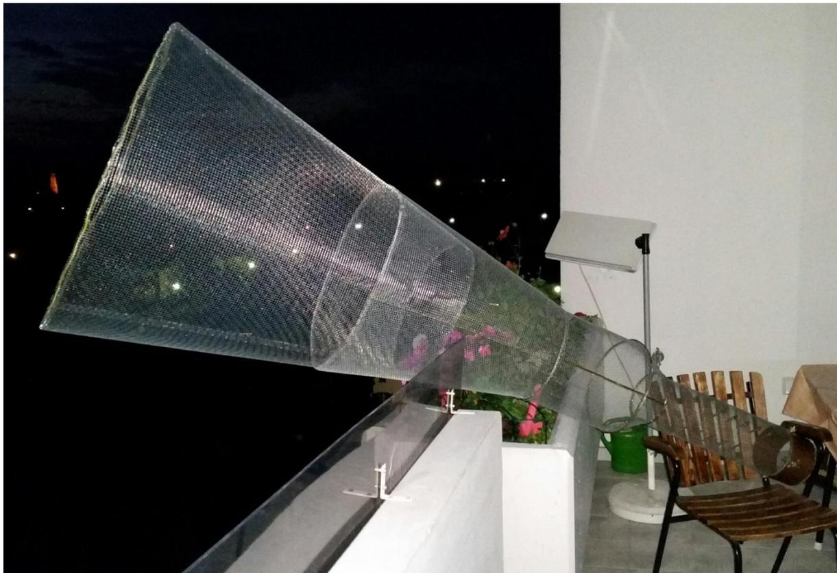
**Hornantenne mit 80cm Durchmesser, 2.3m lang**
