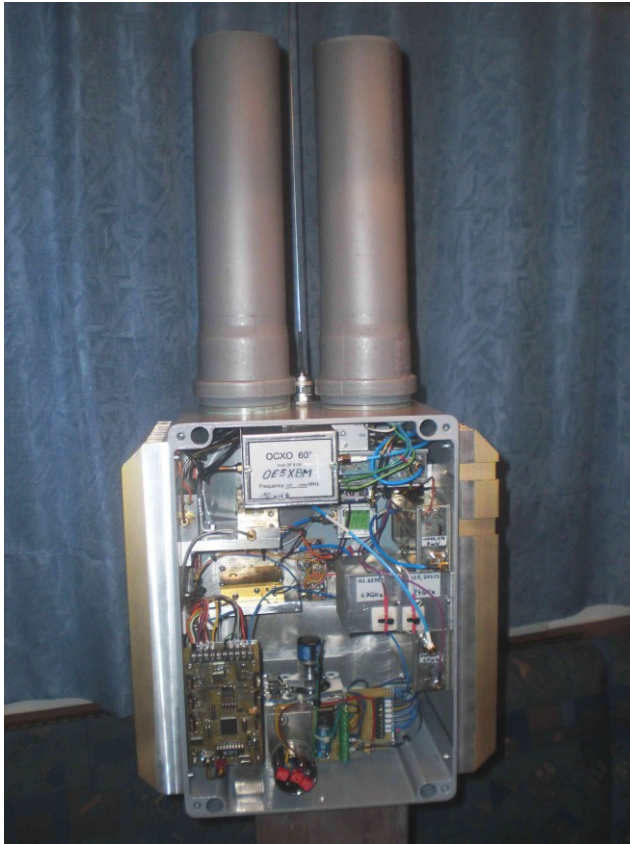
Ansicht von der Rückseite. Oben drauf unter den Kunststoffrohren befinden sich die Hohlleiterschlitzzstrahler für 10 und 24 GHz, dazwischen ist die Fernsteuerantenne.
