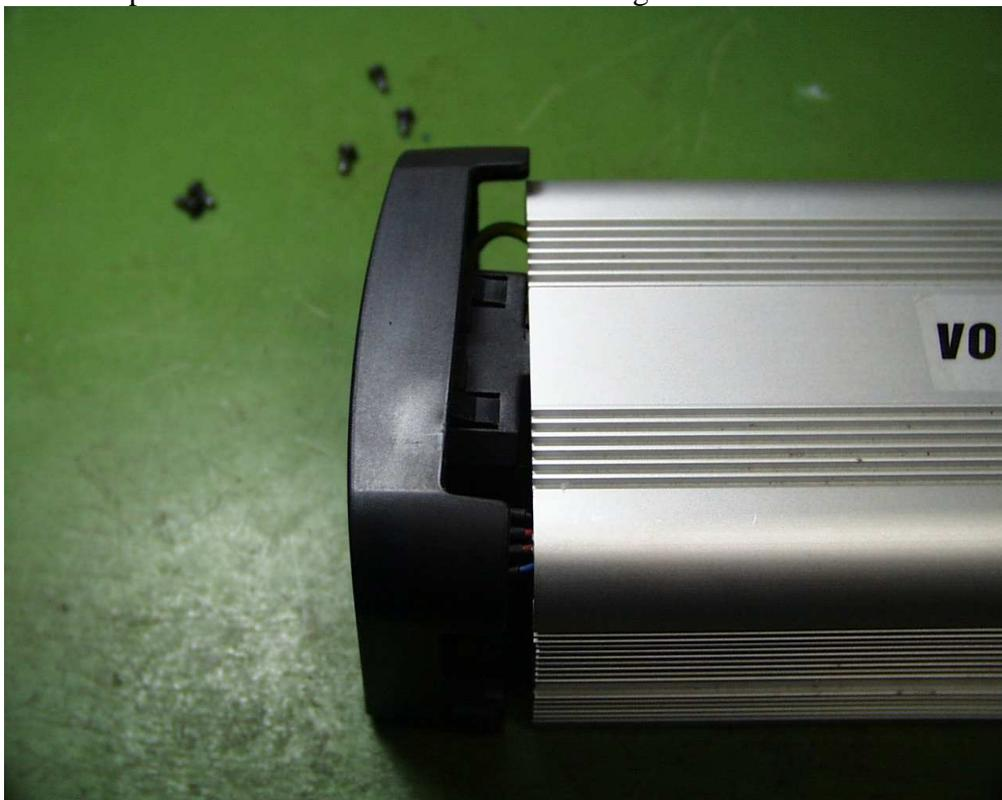
Wenn die beiden LED herausfallen darf man beim Zusammenbau nicht vergessen sie mit Heiß- oder Superkleber wieder zu befestigen.
