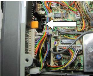
Im linken Bild sieht man das geöffnete Funkgerät von oben, Front links. Die Position des "Freischalt-Schalters" ist unterhalb des orangen Bauteils.
