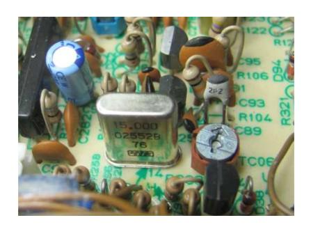
Bei den Quarzen X2001 bis X2004 war zum Teil eine komplette Entfernung des fixen Serienkondensators nötig, um auf die richtige Frequenz zu kommen.
