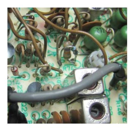
Der Oszillator "Q1026" (X1001) hat laut Schaltplan kein Bauteil zur Abstimmung. Es stellte sich aber heraus, dass die Serien-Induktivität sehr wohl einen "Abgleichkern" besitzt, mit welchem die exakte Frequenz eingestellt werden kann. Bei diesem Oszillator war keine Änderung der Bauteile nötig.
