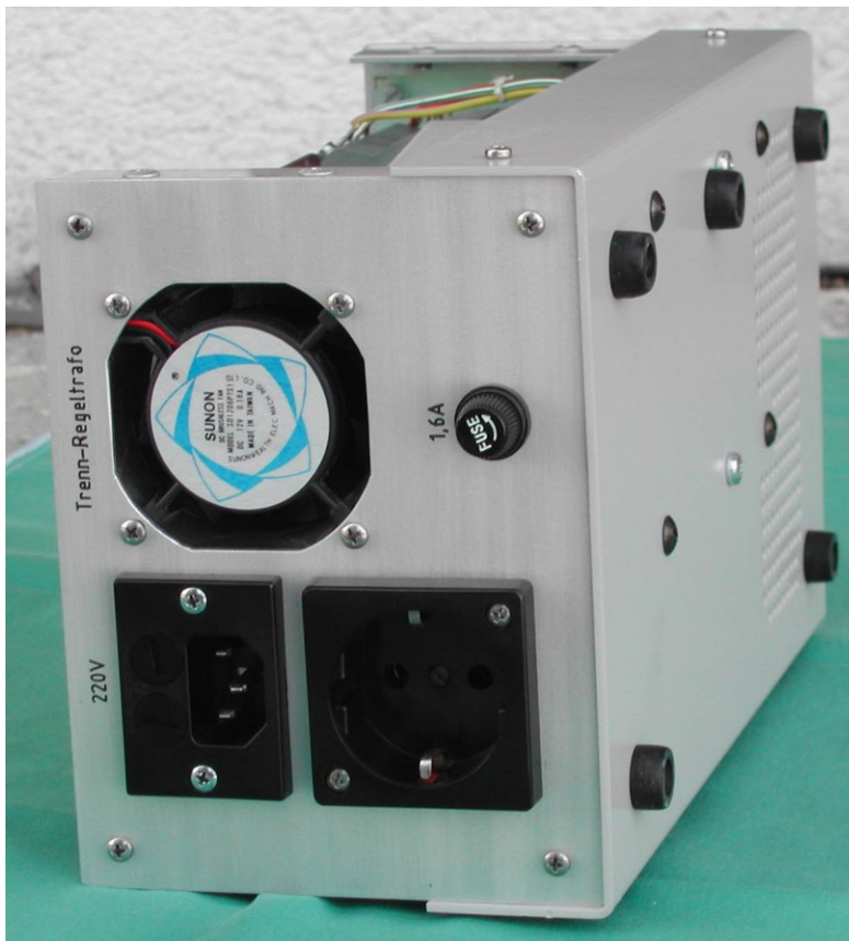
Abb. 9: Rückseite und Unterseite des Gerätes
