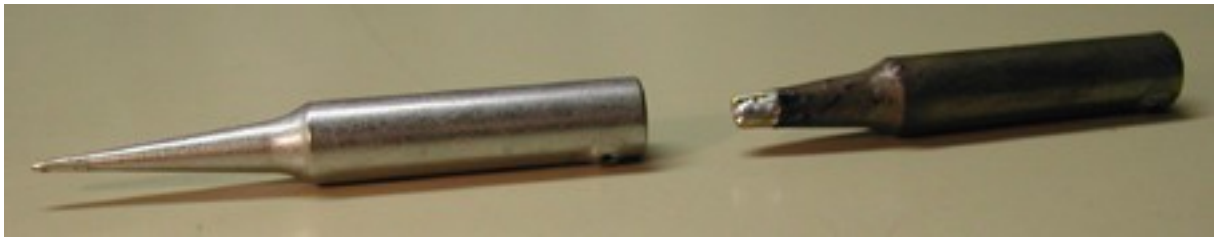
Abb. 1: Muster unterschiedlicher Lötspitzen
