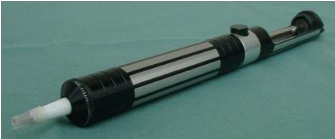
Abb. 1: Der Löt-sauger mit dem Silikonschlauch als Schutz und Verlängerung der Teflonspitze
