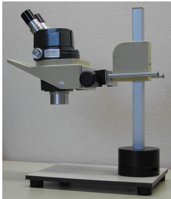
Abb. 13: Instrument mit montierter Horizontalverstellung
