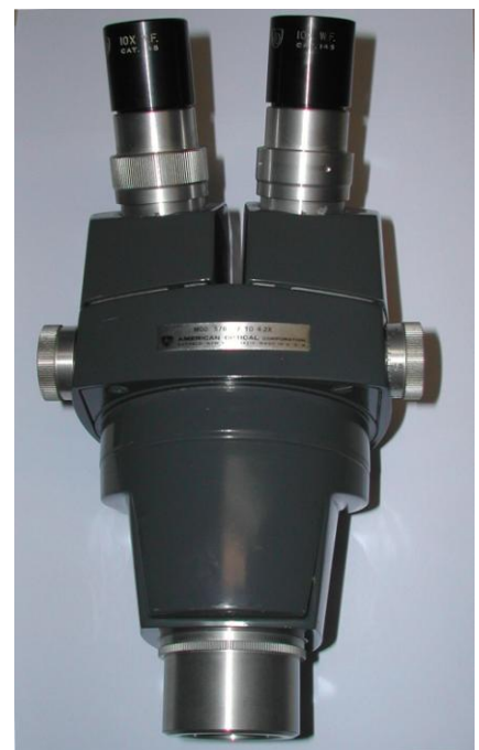
Abb. 1: Stereo-Zoommikroskop mit 0,5er-Vorsatzlinse
