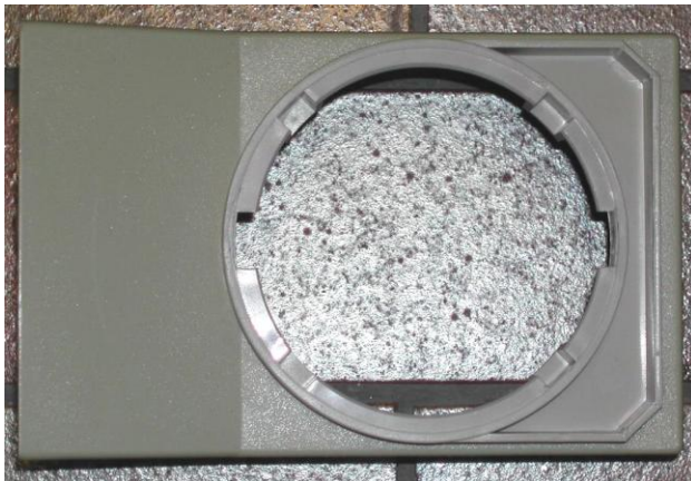
Abb. 5: Fertig bearbeitete Öffnung zur Aufnahme des Mikroskops
