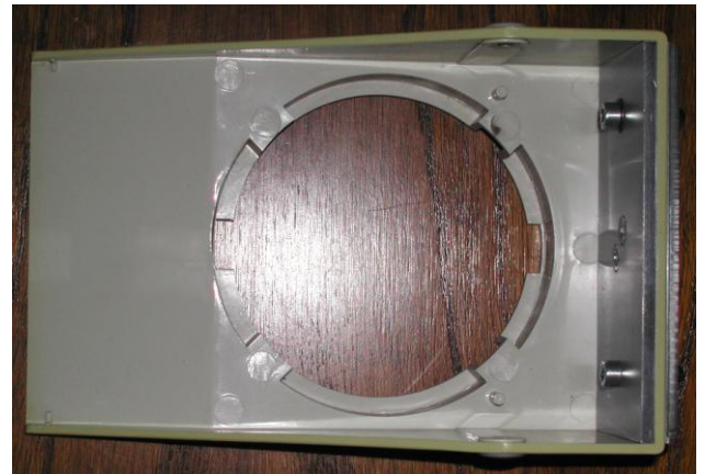
Abb. 6: Unterseite mit Platten zur Versteifung
