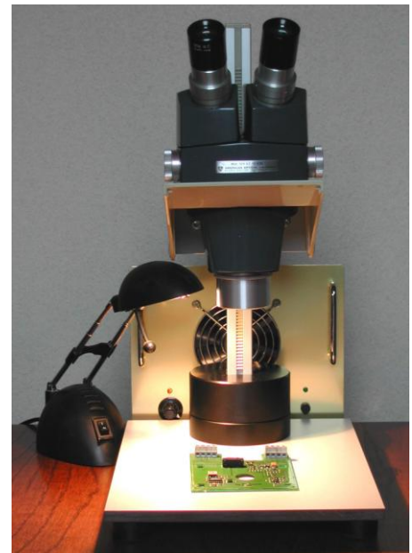
Abb. 14: Fertiges Mikroskop mit Beleuchtung und Lötrauch-Absaugung
