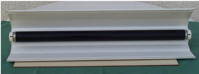
Abb. 2: Die Primitiv-Belichtungslampe
