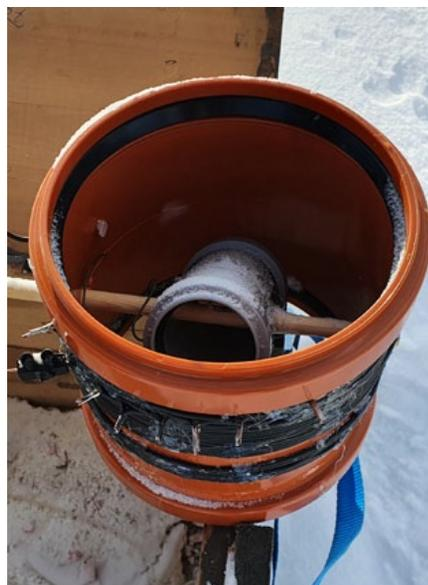
In den meisten Ländern sind 1W ERP erlaubt, um diese zu erreichen braucht es oft 100–200W oder mehr, um diese Strahlungsleistung zu erreichen. Wegen der stark verkürzten Antenne, den Verlusten im Boden und der Umgebung, der Ladespule, ist der Wirkungsgrad nur sehr gering!
