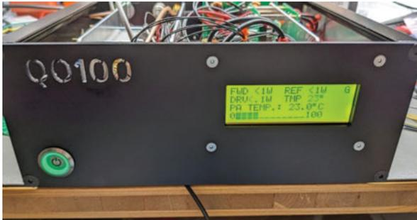
Frontplatte Hauptschalter mit PTT Beleuchtung, Display mit Leistungs-Information der 20W PA, Temperatur, Status des GPSDO
