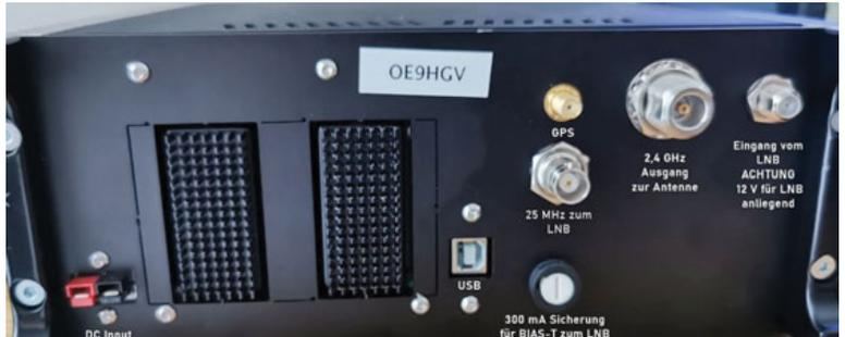
Rückseite Anschlüsse für RX, TX, LNB Takt Versorgung, GPSDO Antenne, USB zum PC und PowerPole Stromversorgung
